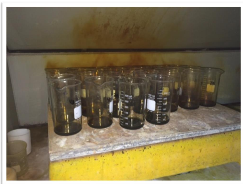
Figura 6.3. Calentamiento de muestras en plancha calefactora.
