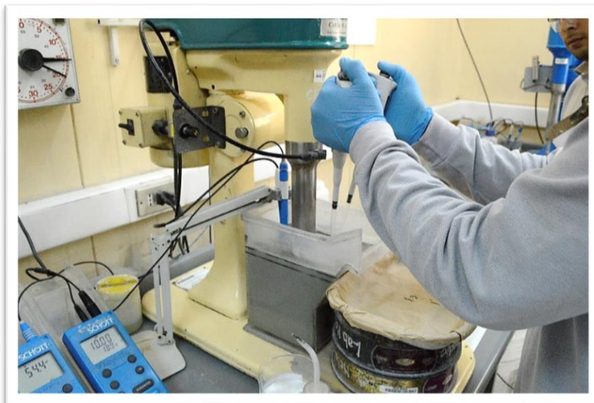
Figura 3.18. Adición de reactivos y acondicionamiento de pulpa (Flotación Lab).
