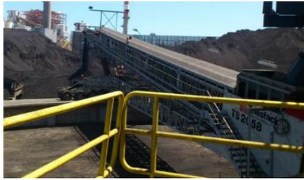
*Ilustración 21: apilador radial*
