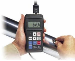
*Ilustración 36: Instrumento medición de espesores, Krautkramer familia DM4*
