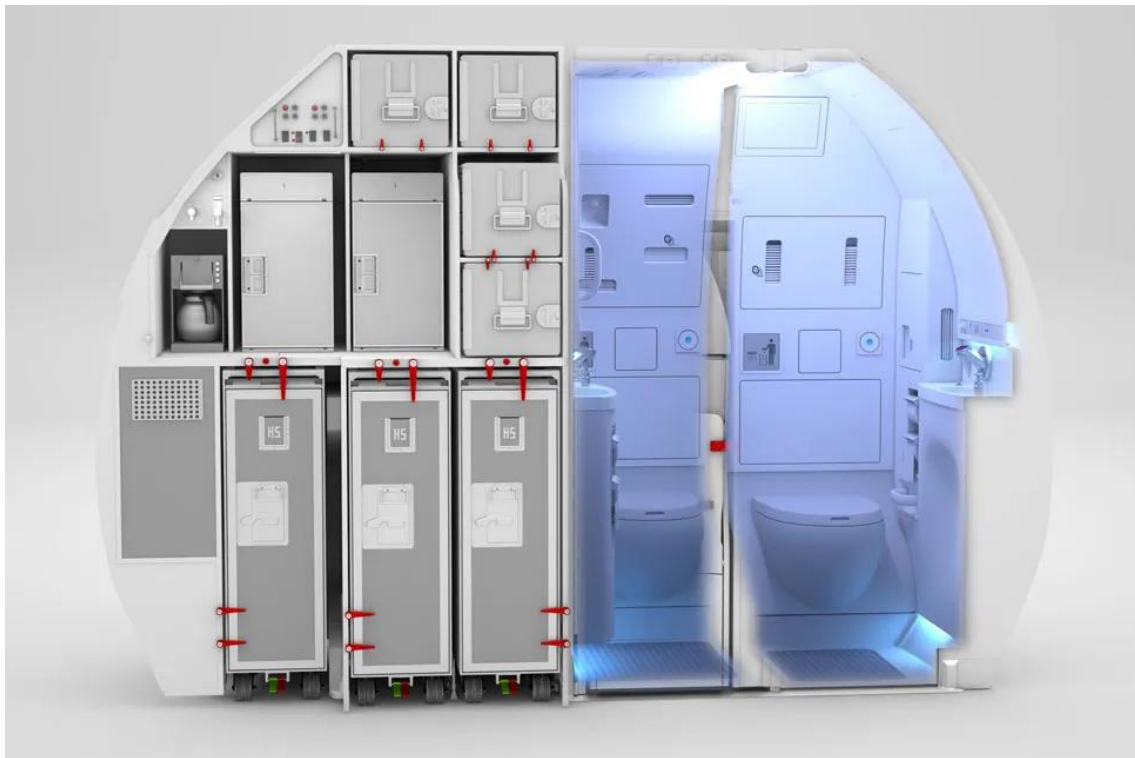
Ilustración 63: Space-Flex v2 lavatory view.
