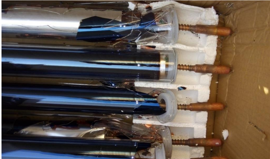
Figura 3. 27 Ruptura de tubos al ser subido a techumbre
