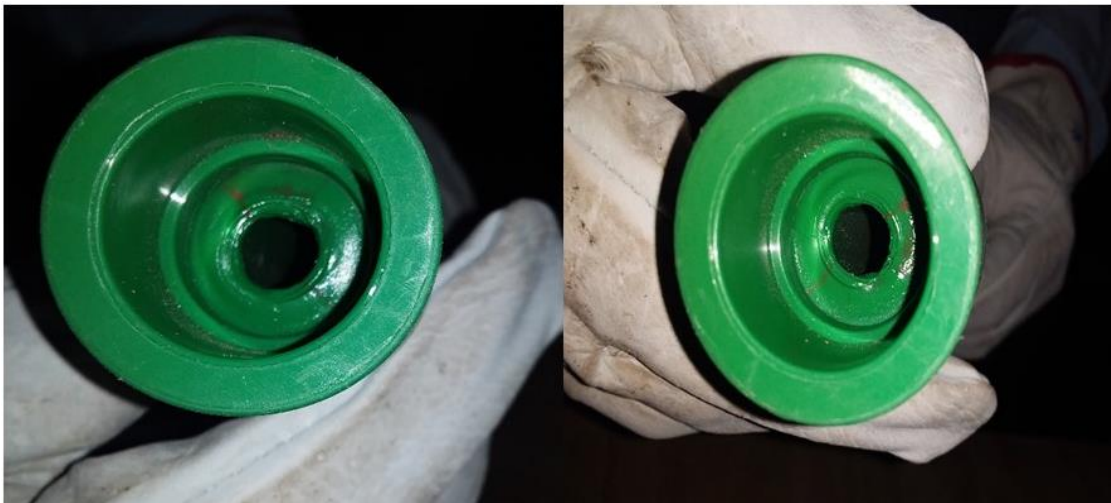
Figura 3. 15 Deformación de pieza por sobre calentamiento en fusionado
