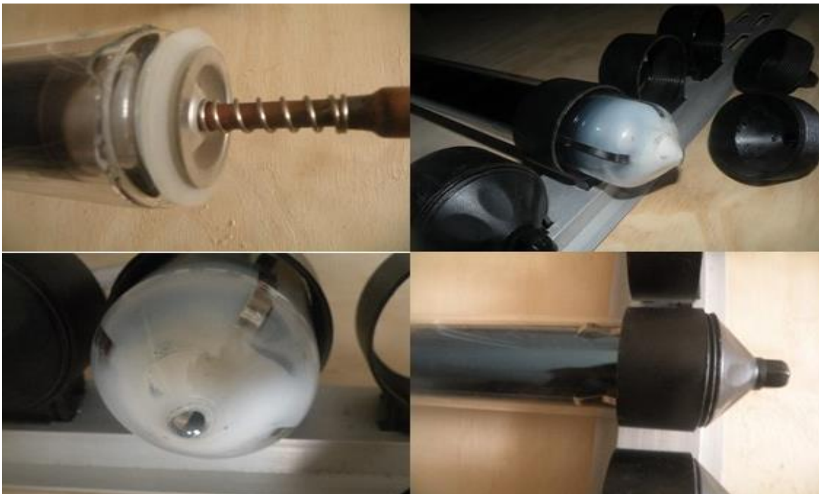
Figura 3. 28 Pérdida de vacío por exceso de apriete en el zapato de fijación
