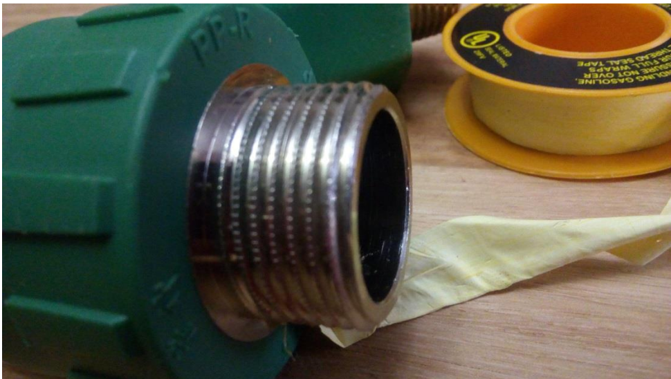
Figura 3. 17 Hilo muesca para fijación teflón Fuente: Elaboración propia – Empresa NATenergy - SAT Minvu
