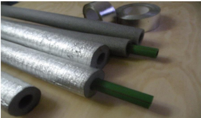
Figura 2. 10 : Tuberías PPR con aislación térmica
