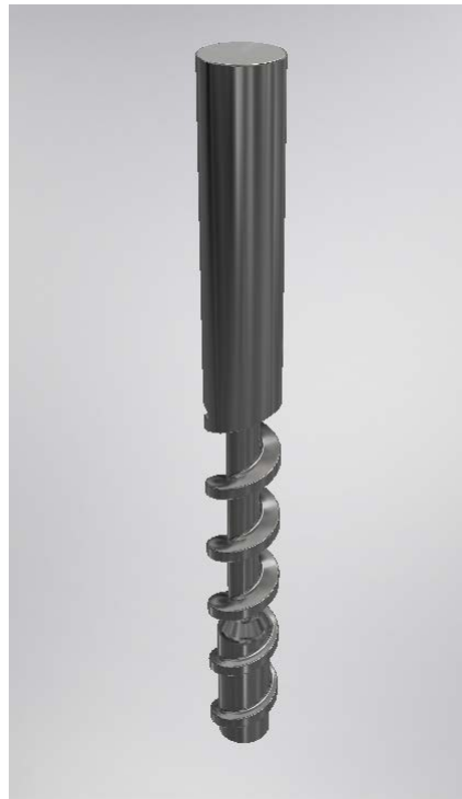
Figura 47: Modelo 3D Geometría Husillo Elaboración Propia, Software Autodesk Inventor.
