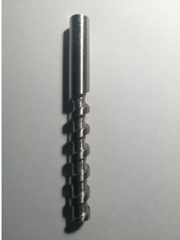
Figura 48: Husillo Fabricado Elaboración Propia, Maestranza Hermano Osorio Quillota.
