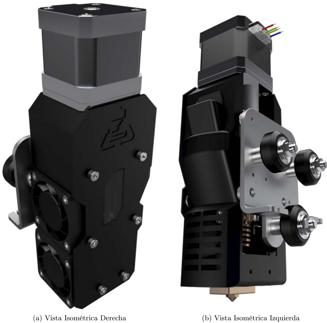
Figura 63: Render del Sistema Extrusor Modular Elaboración Propia, Autodesk Inventor
