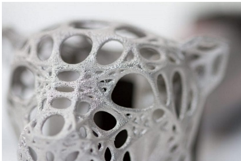
Figura 12: Producto o pieza conformada mediante DMLS, Sintetización Directa láser. Alta complejidad de pieza.
