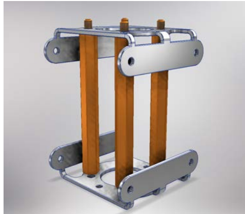
Figura 55: Diseño de Estructura Sistema Extrusor. Elaboración Propia: Modela 3D Autodesk inventor
