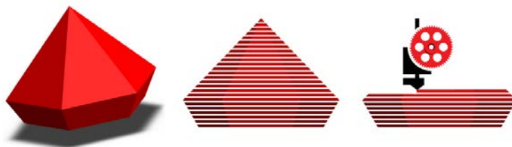
Figura 9: Modelado 3D, discretización de las capas y conformación de la pieza mediante fabricación aditiva
