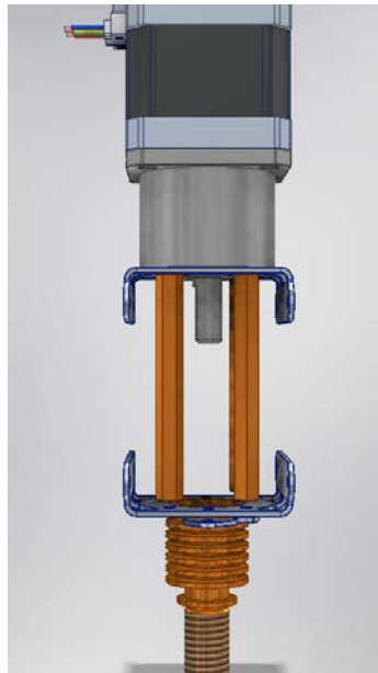
Figura 56: Ensamble Sistema Estructura con Componente Hot-End y Motor Elaboración Propia: Modela 3D Autodesk inventor
