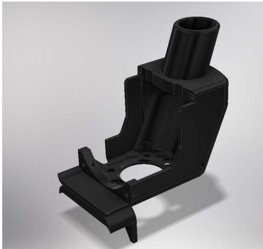
Figura 53: Diseño de Tolva Elaboración Propia: Modelo 3D Autodesk inventor
