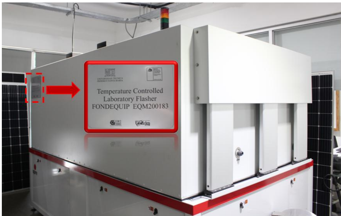
Figura 8: Simulador solar tipo TCLF del Laboratorio Solar Indoor UTFSM.
