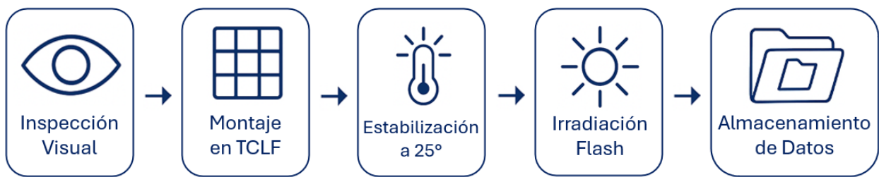
Figura 9: Protocolo de adquisición de curvas I-V con simulador TCLF.
