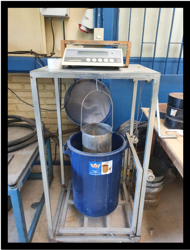
Figura 17 Pesa lavado sumergido Fuente: Recuperada de Laboratorio de Hormigón, UTFSM Sede Concepción, (2022).
