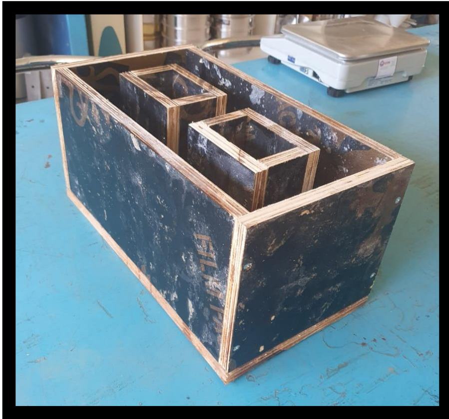
Figura 27 Moldaje bloque hormigón fabricado Fuente: Elaboración propia, (2022).
