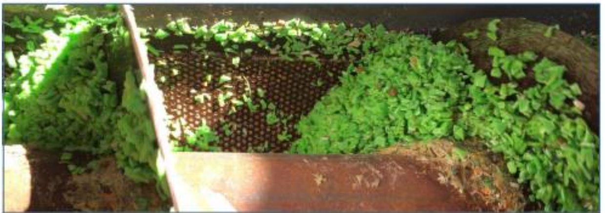
Figura 7 Lavado Pellet de PEAD Fuente. Recuperadas de Bioplasti. (Bioplasti, 2018)
