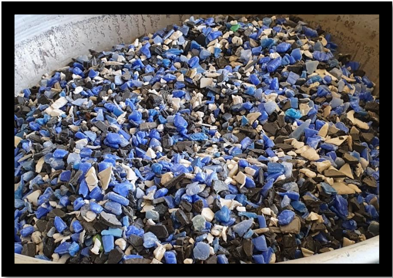
Figura 10 PEAD reciclado (Árido Grueso) Fuente: Elaboración Propia (2022).
