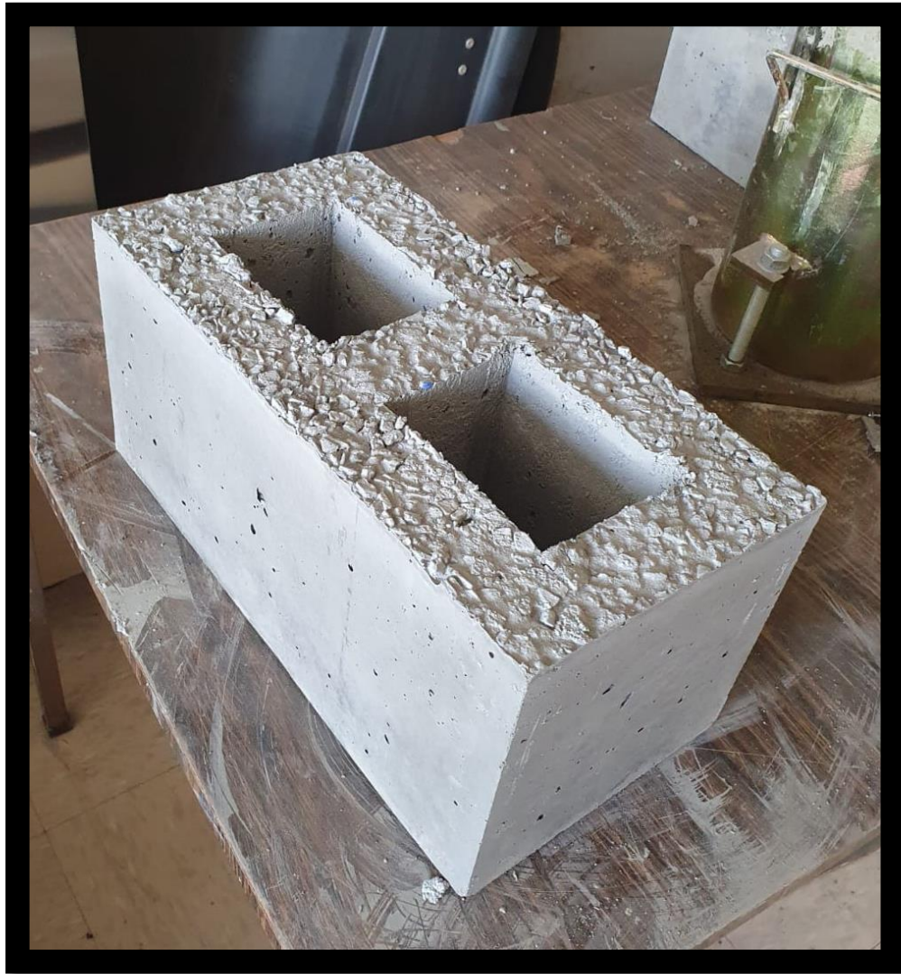
Figura 36 Bloque de hormigón experimental desmoldado Fuente: Elaboración Propia, (2022).
