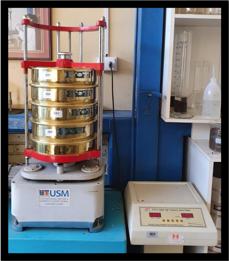
Figura 22 Granulometría árido grueso Fuente: Recuperada de Laboratorio de Hormigón, UTFSM Sede Concepción, (2022).
