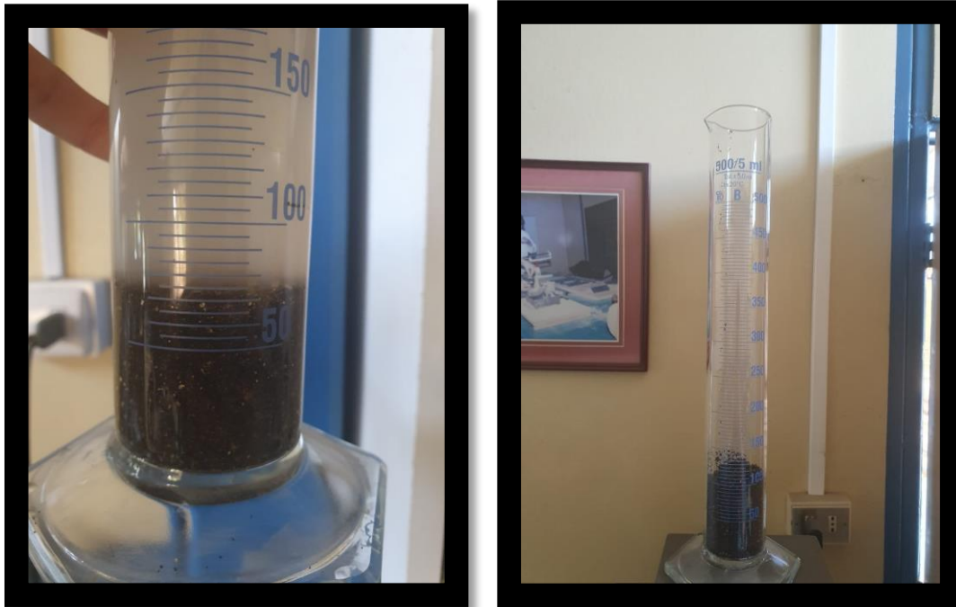
Figura 24 Ensayo esponjamiento Fuente: Recuperada de Laboratorio de Hormigón, UTFSM Sede Concepción, (2022).
