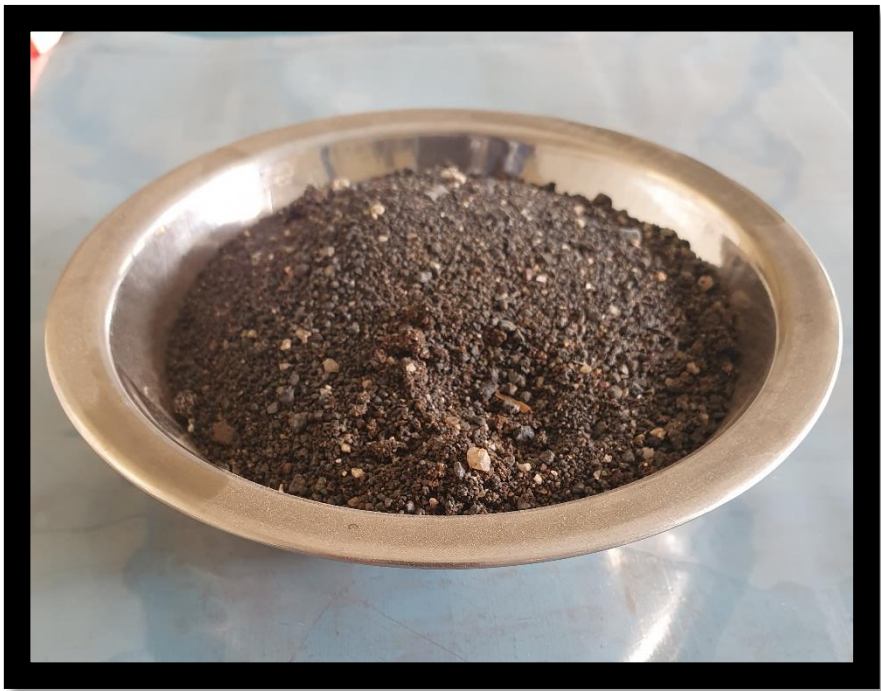
Figura 12 Arena (Árido fino) Fuente Elaboración propia
