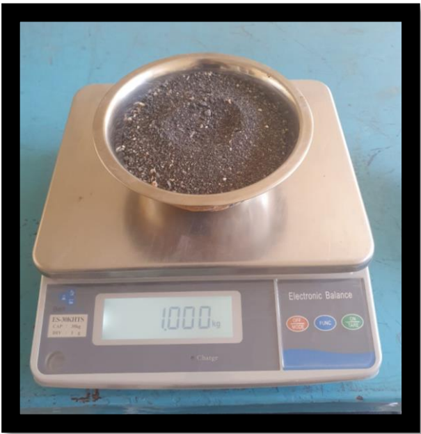
Figura 19 Granulometría Árido Fino Fuente: Recuperada de Laboratorio de Hormigón, UTFSM Sede Concepción, (2022).
