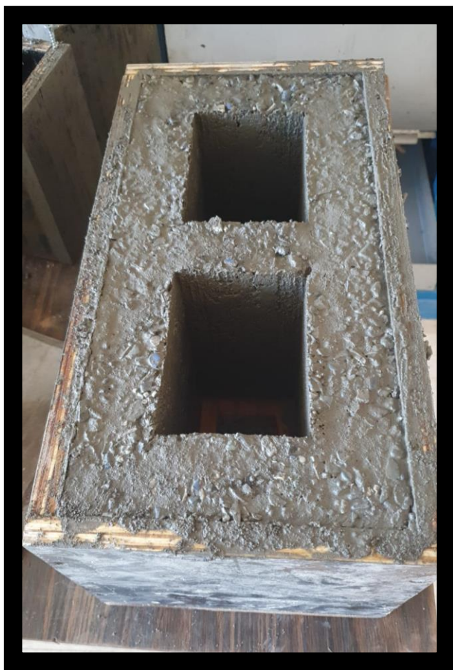
Figura 35 Hormigón fraguado y moldajes interiores extraídos Fuente: Elaboración Propia, (2022).
