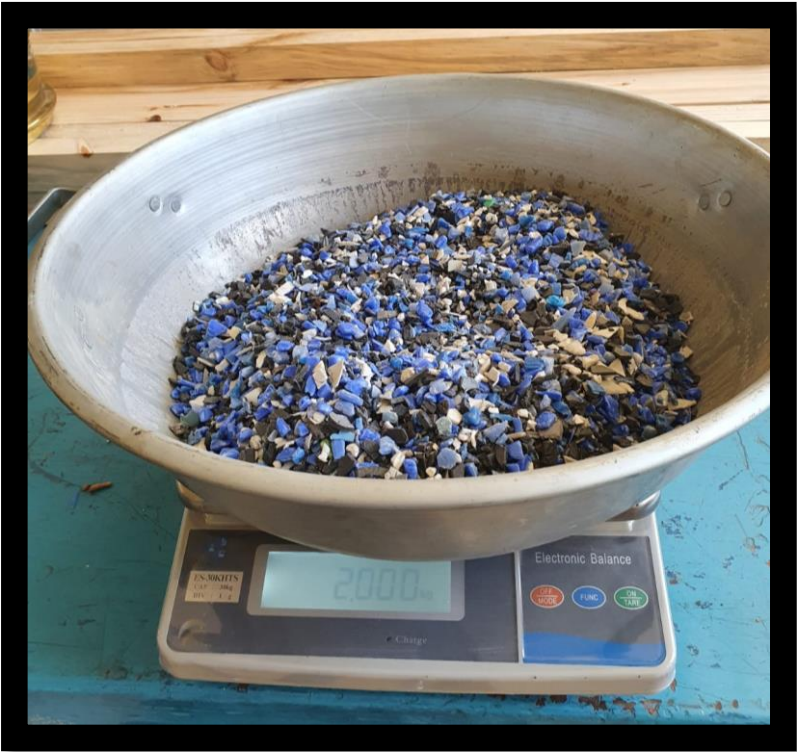
Figura 21 Árido grueso Peso inicial 2 Kg Fuente: Recuperada de Laboratorio de Hormigón, UTFSM Sede Concepción, (2022).
