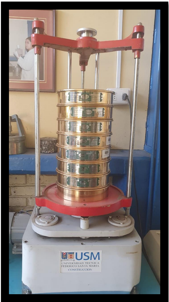
Figura 19 Granulometría Árido Fino Fuente: Recuperada de Laboratorio de Hormigón, UTFSM Sede Concepción, (2022).
