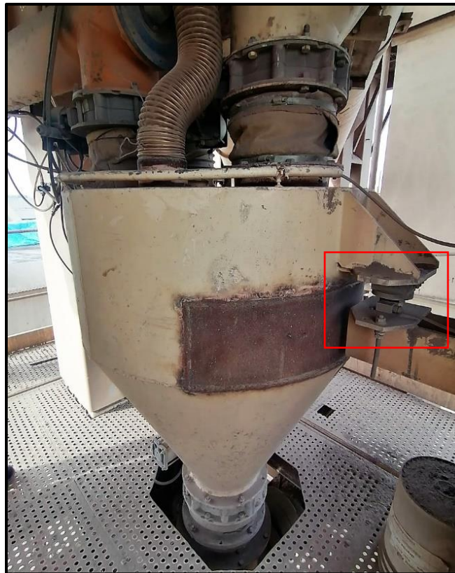
Figura 2.17. Contenedor de filler montado en celdas de carga (Planta Bitumix Maipú). Fuente: Elaboración propia.
