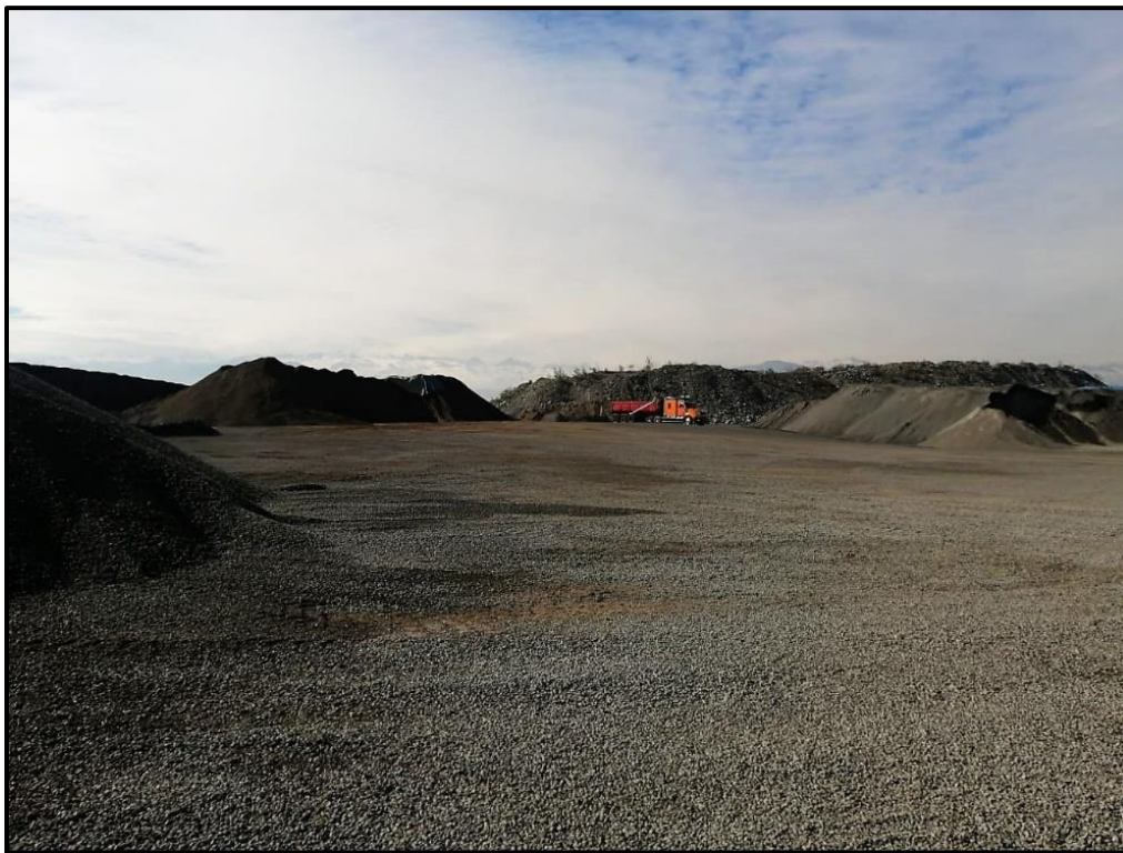
Figura 2.4. Acopio de áridos (Planta Bitumix Maipú). Fuente: Elaboración propia.
