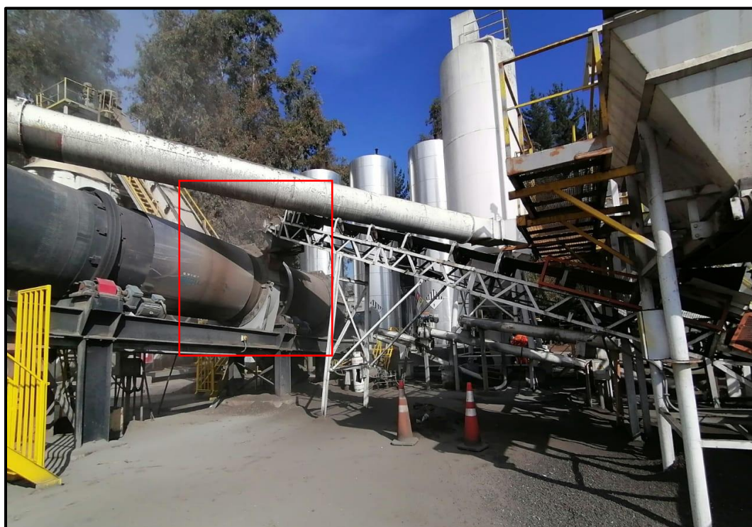
Figura 2.27. Introducción de RAP en el tambor (Planta Bitumix Rancagua). Fuente: Elaboración propia.
