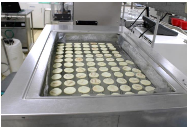
Figura 13. Disposición de las muestras en equipo de ventana refractiva y esquema del sistema propuesto.
