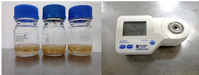
Figura 18. Preparación de muestras para medición de sólidos solubles y equipo utilizado.
