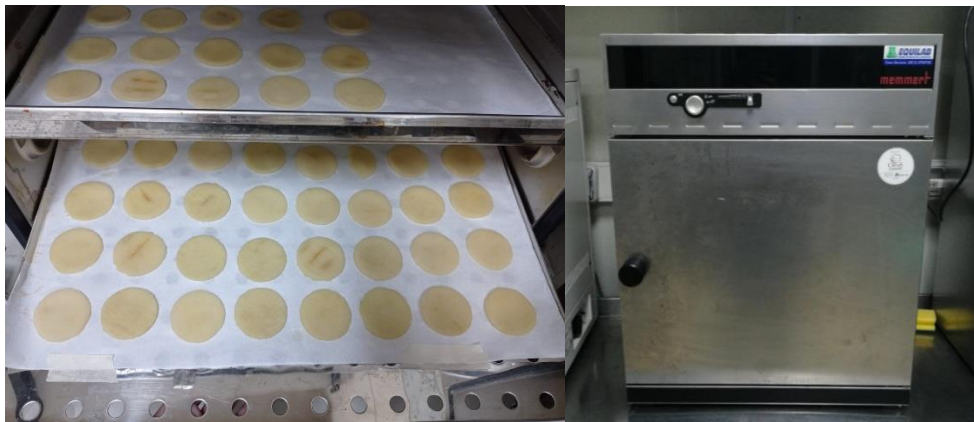
Figura 12. Disposición de las muestras en el equipo y estufa utilizada.
