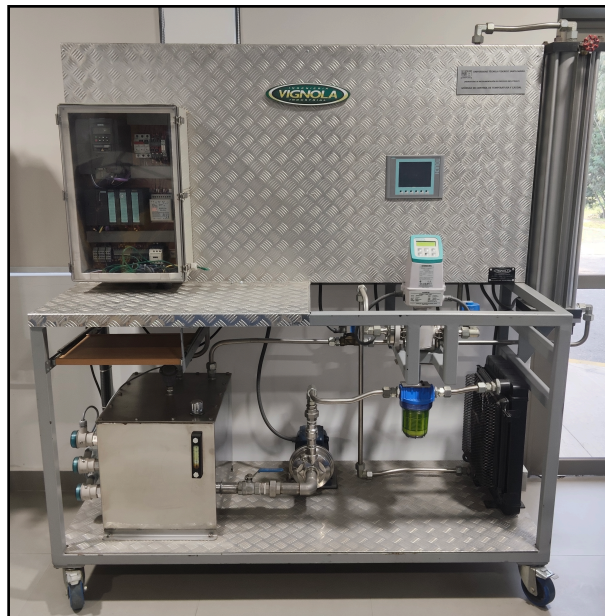
Módulo de control de temperatura y caudal
