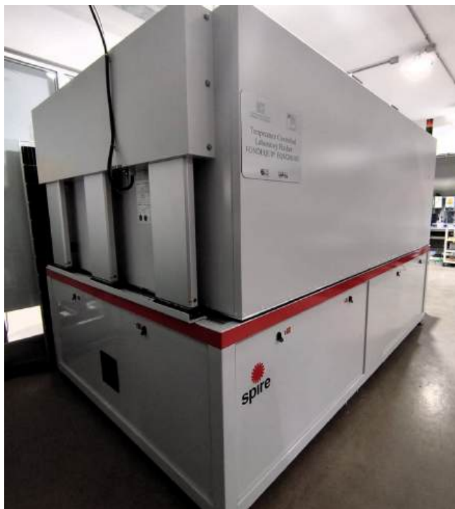
Figura 4.1: Simulador solar TCLF de Eternalsun Spire empleado para curvas I-V [35].
