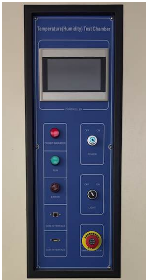
Figura 4.4: Panel de control de la cámara climática. Se observan el indicador de alimentación (Power indicator), el indicador de operación (Run) y el de fallo (Error); el pulsador de emergencia; el interruptor con llave de encendido (Power); el selector de luz interna (Light); e interfaces de comunicación Ethernet y USB (Com interface) para registro de datos.
