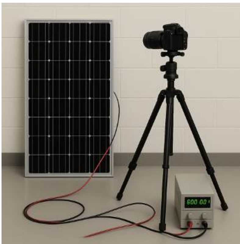
Figura 4.2: Montaje de electroluminiscencia (módulo, fuente de poder, cámara y auxiliares). Generado con IA.
