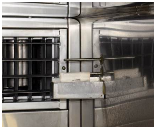
Figura 4.7: Humidificador de la cámara climática conectado al estanque de agua purificada.
