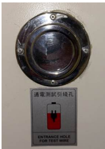
Figura 4.9: Entradas herméticas para cableado y conexión de módulos desde el exterior.
