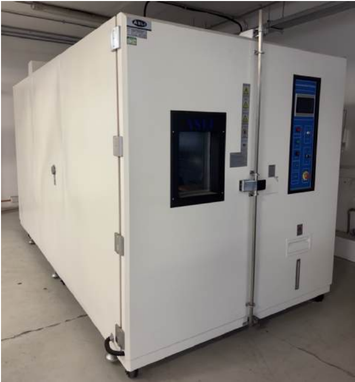
Figura 4.3: Vista general de la cámara climática utilizada para los ensayos de ciclado térmico.
