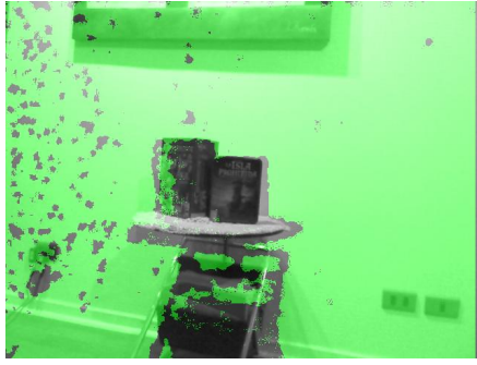
Fig. 4.1: Segmentación realizada con la imagen de profundidad sin corrección.
