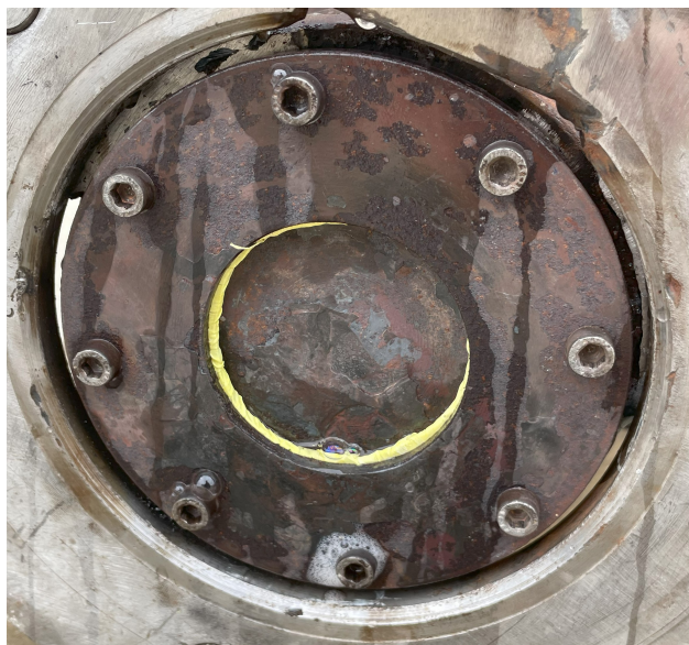
Figura 3.27: Burbujeo en pernos de placa receptora.
