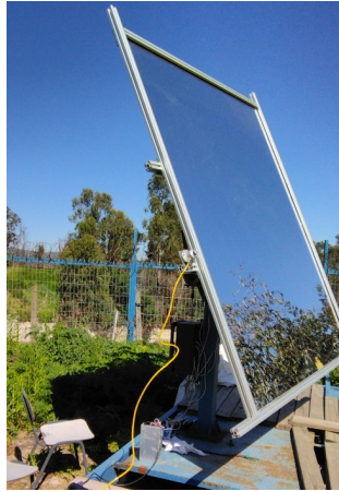
Figura 2.2: Helióstato solar del proyecto (Fuente: propia).
