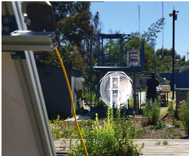
Figura 3.19: Proyección de radiación generada por heliostato.
