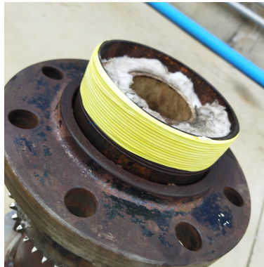
Figura 3.21: Rosca de tapa de suministros con teflón.
