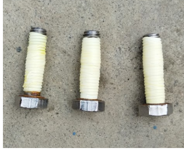
Figura 3.22: Pernos para zona de termocuplas con teflón.
