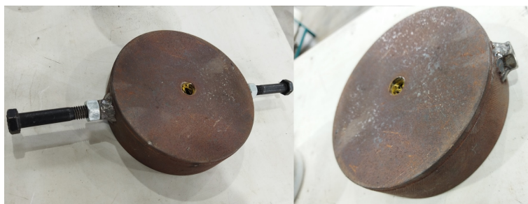
Figura 3.20: Tapa de entrada de reactivos, con los pernos ubicados para mejor agarre.
