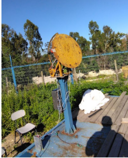
Figura 3.18: Soporte de heliostato con movimiento por accionamiento eléctrico
