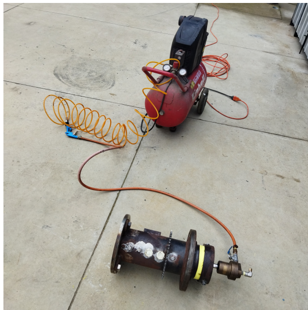
Figura 3.24: Setup prueba de estanqueidad
