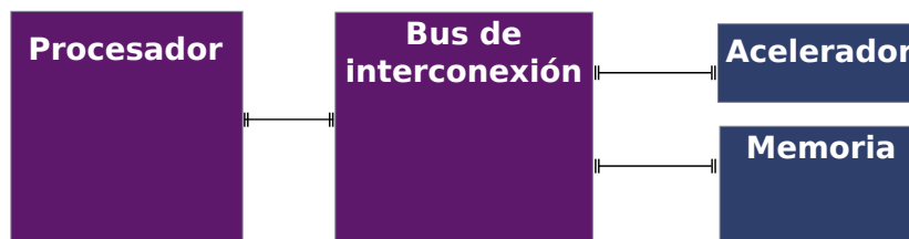
Figura 2.1: Estructura genérica de un sistema heterogéneo sobre FPGA: el procesador accede a los aceleradores y a la memoria a través de un bus de interconexión común. Componentes morados actúan como Maestro y componentes azulados actúan como clientes
