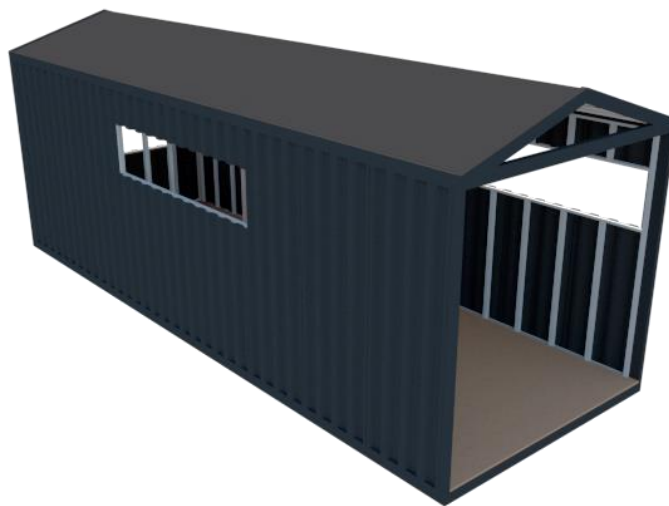
Ilustración 2.2.3.7 Instalación terciado, piso y tabiquería.
