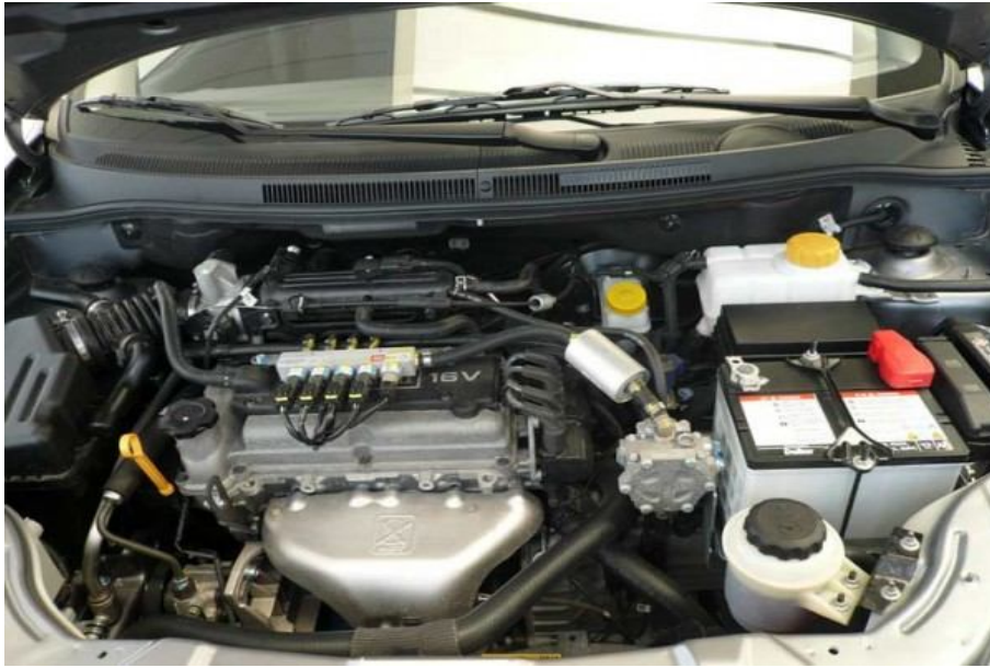
Fotografía 6: Kit de conversión a GLP básico instalado en un motor a gasolina
