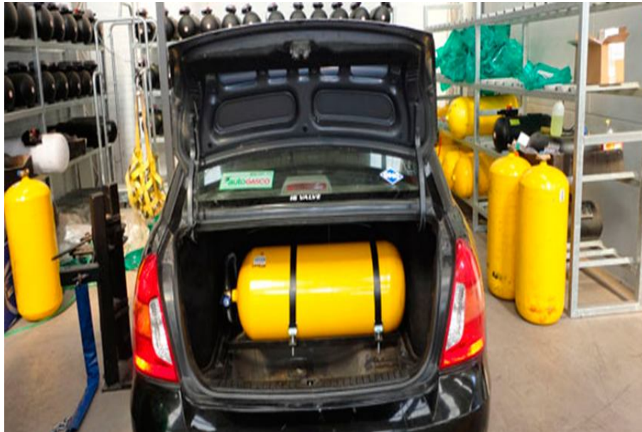
Fotografía 3: Estanque de GNC instalado en un vehículo a gasolina
