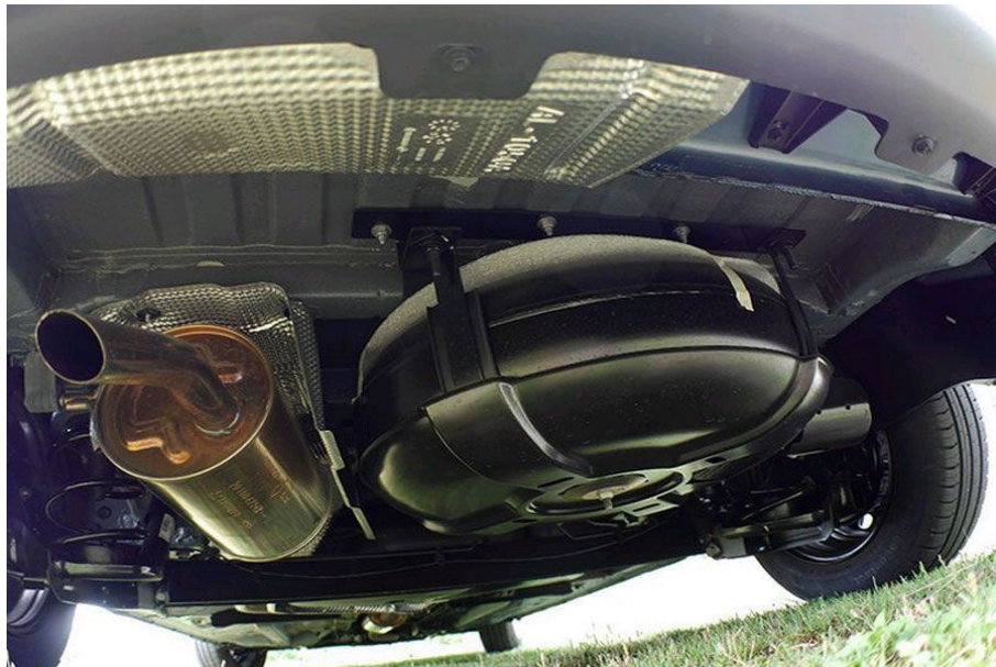
Fotografía 2: Estanque de GLP toroidal instalado en un vehículo a gasolina
