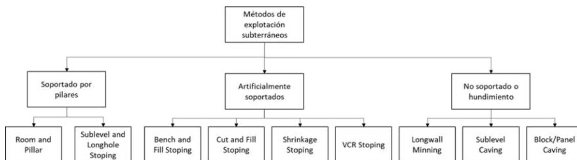
Figura 2.1: Clasificación para los métodos de explotación subterráneos por Brady & Brown (González 2018).
