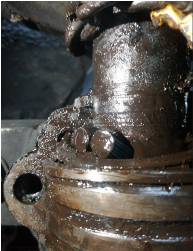
figura - 3-1: Rotura de rodamiento por partículas de coque. Fuente: Elaboración propia.
