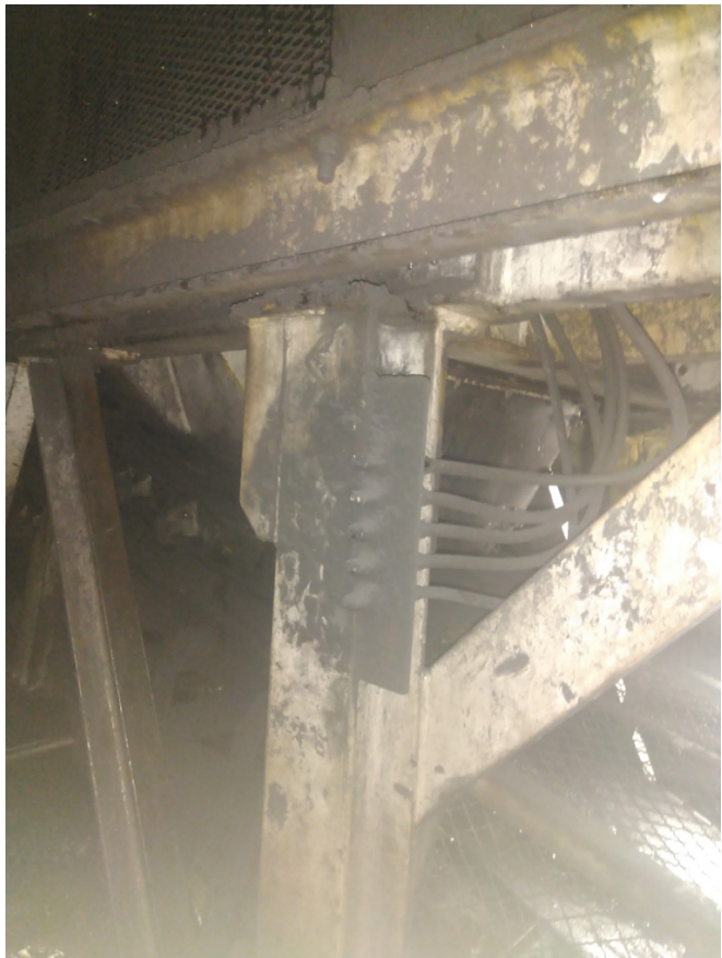
figura - 1-8: Puntos de engrase de descansos de polines. Fuente: Elaboración propia.
