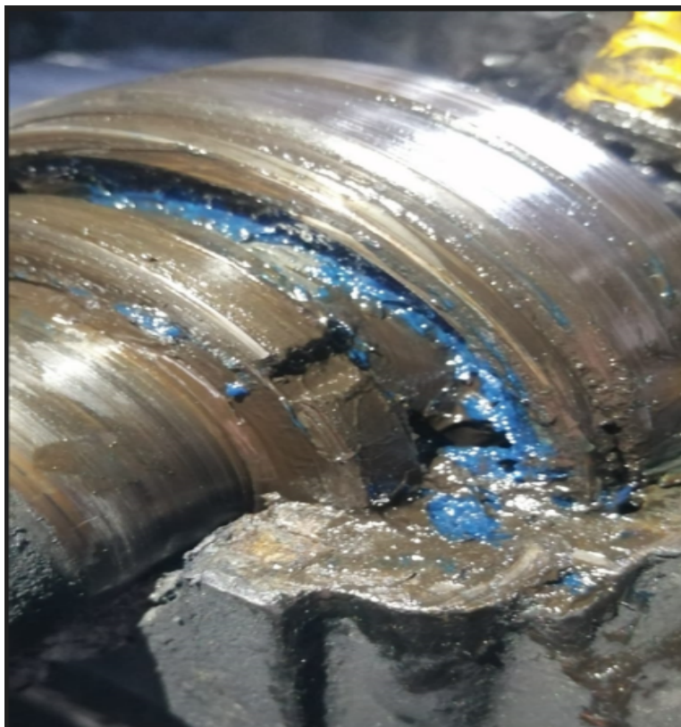
figura - 2-11: Exceso de lubricación.
