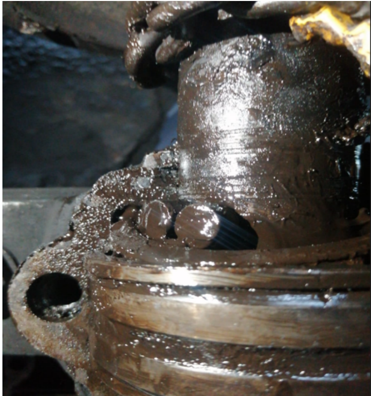
figura - 2-10: Rodamiento descanso contaminado.
