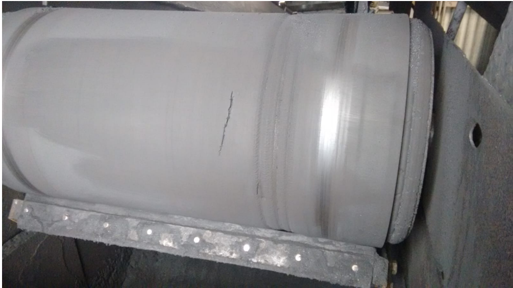
figura - 1-5: Verificando fisuras en cinta.
