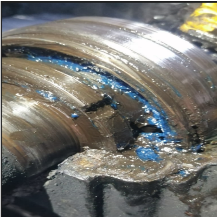
figura - 3-2: Pérdida de propiedades de la grasa por alta temperatura. Fuente: Elaboración propia.
