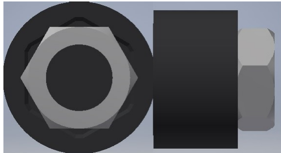
Figura 3: Acople fallido entre dado de impacto y tuerca. Fuente: Elaboración propia.
