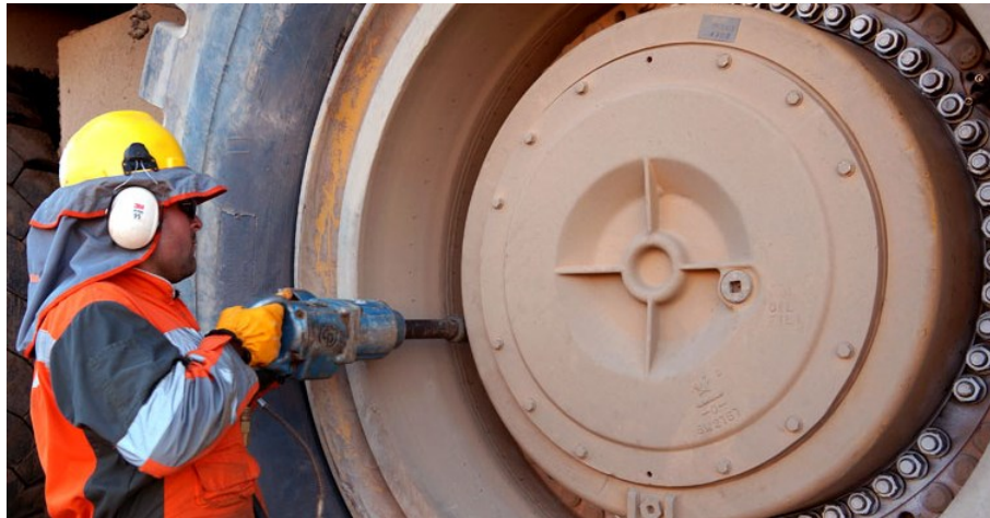
Figura 1: Operario realizando la tarea de Instalar/Extraer tuercas de una llanta OTR.
