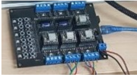
Figura 76: Placa controladora arduino CNC de 6 ejes utilizada en el arreglo.
