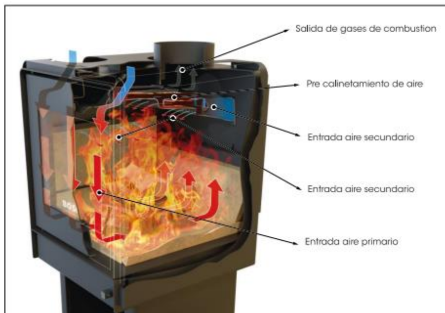
Figura 2.10 Sistema de doble combustión estufa Bosca [18].
