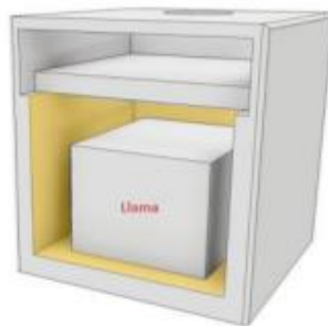
Figura 3.7 Cámara de combustión calefactor residencial marca BOSCA modelo Spirit 380: (a) geometría, materiales y propiedades termo-físicas reales de la cámara de combustión; y (b) modelo aproximado de la cámara de combustión.
