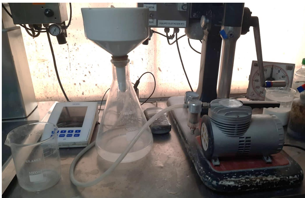
Figura 3.2. Sistema de filtrado al vacío para pretratamiento de aguas en Laboratorio Metalúrgico El Soldado.
