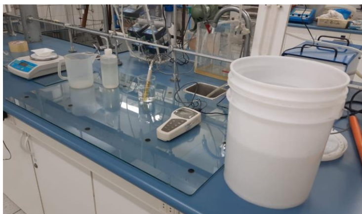
Figura 3.4. Sistema de preparación de Agua de Procesos Salobre.
