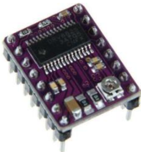
Figura 94: Controladores de motores, a) regulado mediante potenciómetro, b) regulado por interruptores. [8]
