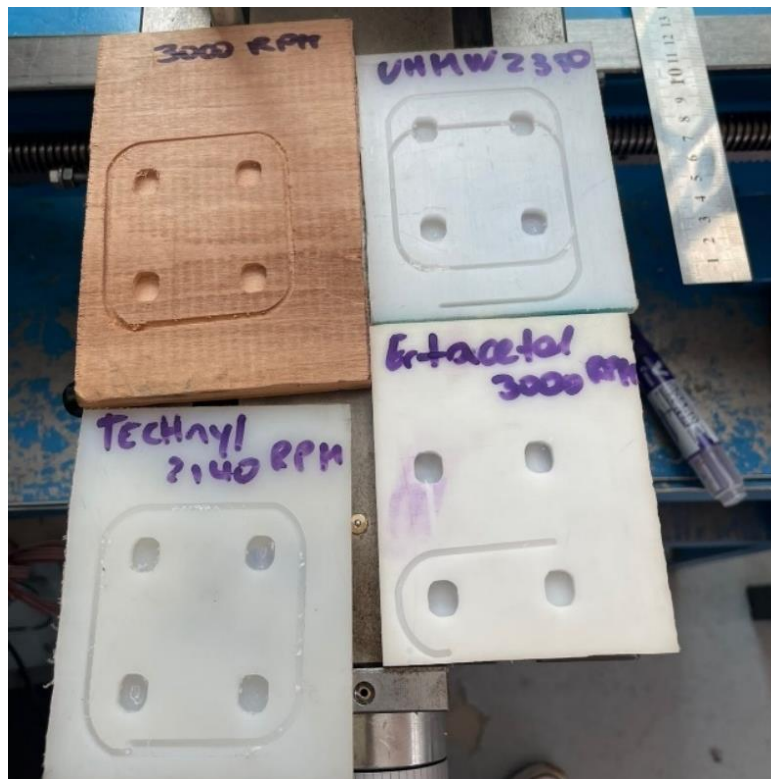
Figura 73: Pruebas de mecanizado simple en distintos materiales a distintas revoluciones por minuto.
