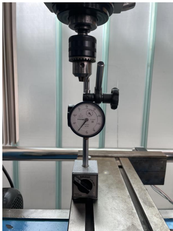
Figura 87: Proceso de calibración eje Z, mediante reloj comparador y función Settings de Mach3
