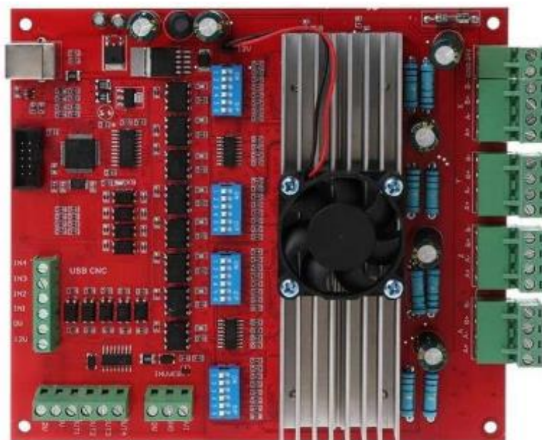
Figura 95: Placa controladora con controladores de motores incluidos. [8]
