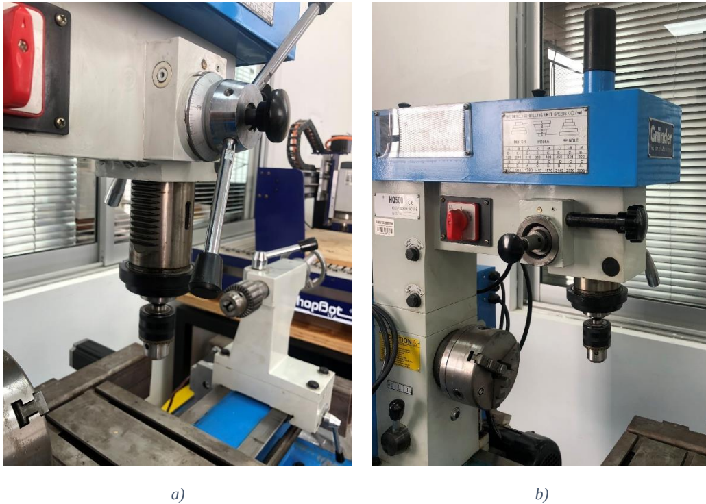
Figura 40: Imágenes del cabezal de la fresadora desde distintos puntos de vista, sin modificaciones. a) Muestra la palanca del avance macro b) Imagen desde otra perspectiva donde se puede ver la manilla (negra) de avance fino.
