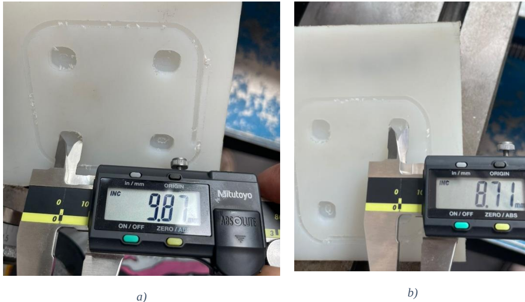
Figura 74: mediciones de las perforaciones circulares de diámetro 10 [mm]. a) medición de la longitud de perforación de manera horizontal. b) medición de la longitud de perforación de manera vertical (posición de la imagen esta rotada en 90 para que se aprecie la medición con el pie de metro)
