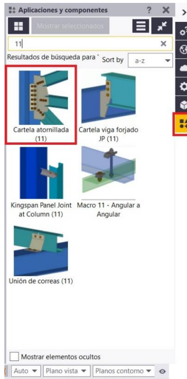
Figura 19: Creación de conexiones en Tekla Structures.
