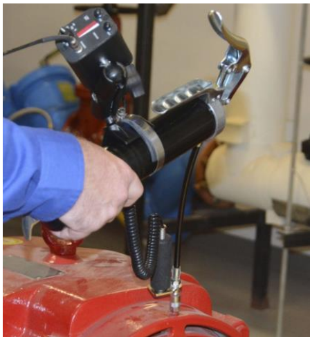
Figura 1. Instalación del equipo de ultrasonido en pistola de engrase a través de abrazadera ajustable
