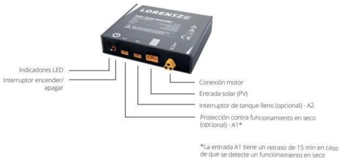
Ilustración 3-36: Entradas del controlador Lorentz PS2 100 Fuente: Partnernet Lorentz.
