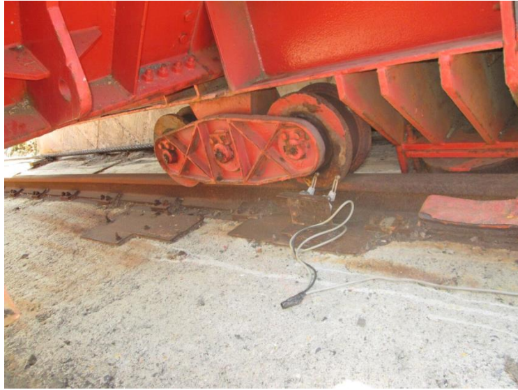
Figura 55: Rodado vertical y horizontal del carro.
