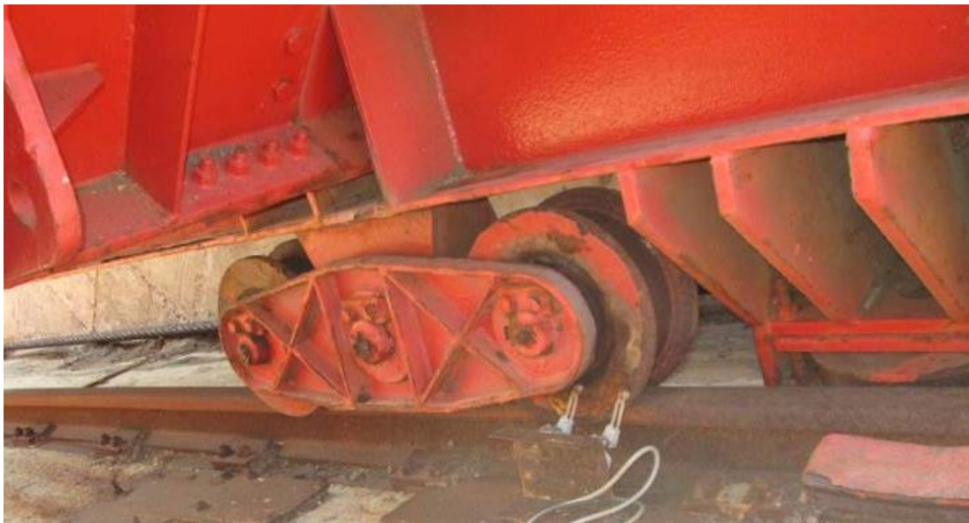
Figura 25: Ruedas sobre riel y rueda horizontal con función guía y anti-vuelco.
