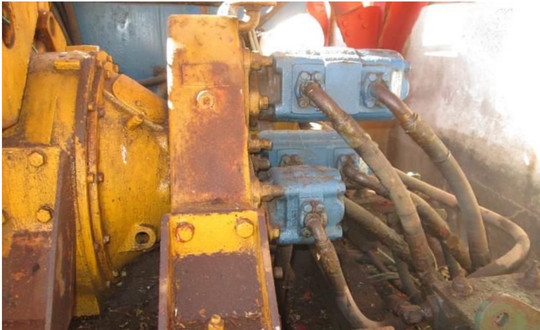
Figura 14: Bombas hidráulicas accionadas por el Motor Diesel.
