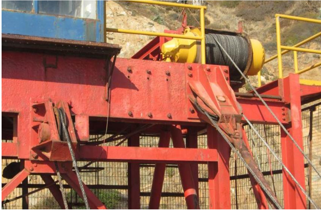
Figura 18: Winche oleohidráulico y poleas de reenvío, desvío.
