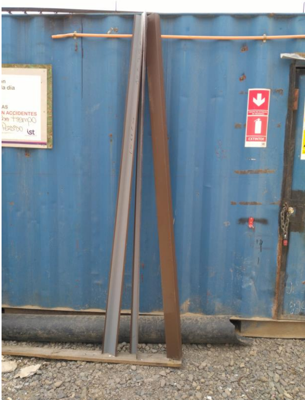
Figura2- 11 perfileria de coronación de esquinero
