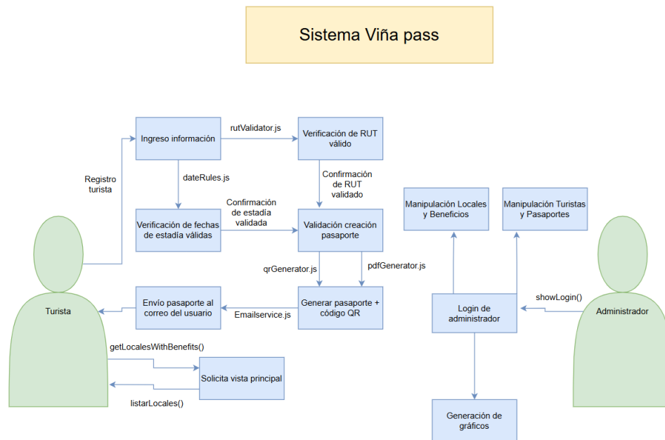
Figura 4.2: Diagrama de arquitectura del sistema Viña Pass y relación entre sus módulos funcionales.
