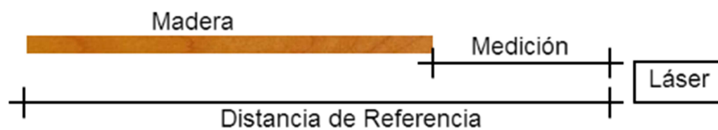
Figura 7. 3 Obtención de longitud de la madera.
