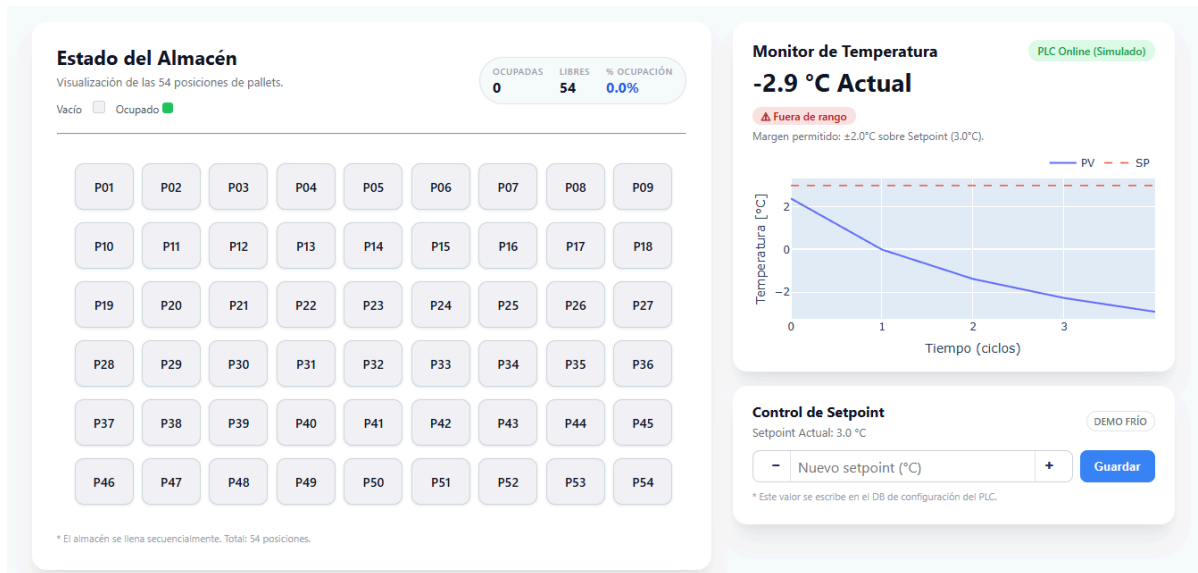
Figura 4.6. Dashboard local con matriz de 54 posiciones, monitor de temperatura y ajuste de consigna. Fuente: captura DASHBOARD LOCAL.png [P7].
