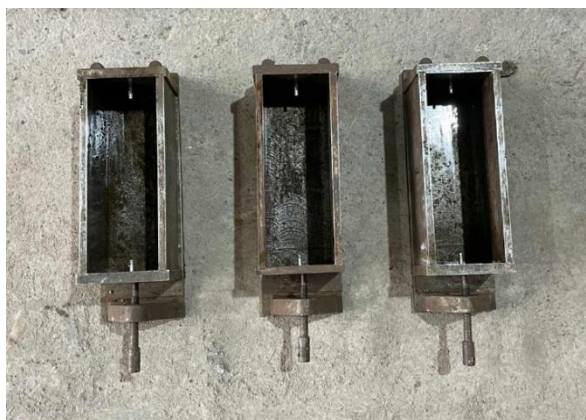
Figura N° 11 Moldaje de probetas acondicionadas con aceite mineral.
