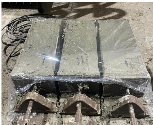
Figura N° 16 Probetas cubiertas con lámina plástica para curado inicial.
