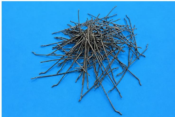
Figura N° 9 Fibras de acero utilizadas en estudio.
