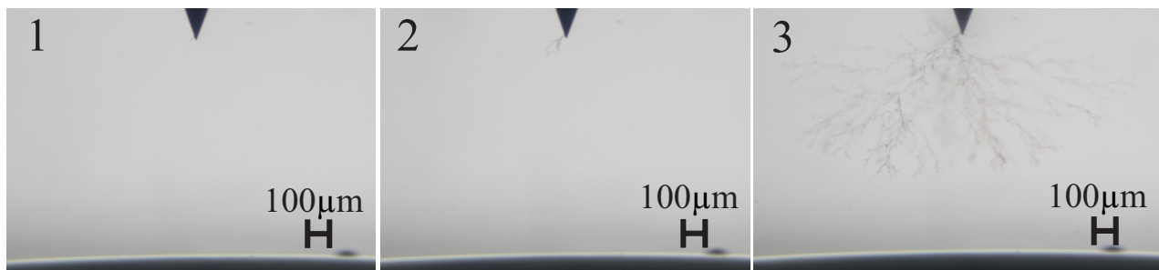
Figura 4.43: Etapas 1, 2 y 3 de los árboles eléctricos bajo fundamental + undécima armónica sin desfase.
