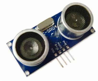
Figura 2-4. Sensor ultrasónico HC-SR04
