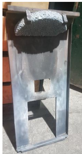
Figura 4.29: Pared trasera de la cámara de combustión en configuración 2
