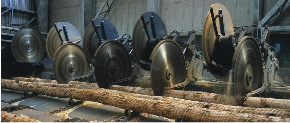
Figura 1-24 Sierras circulares línea de trozado (Fuente: fotografía propia)
