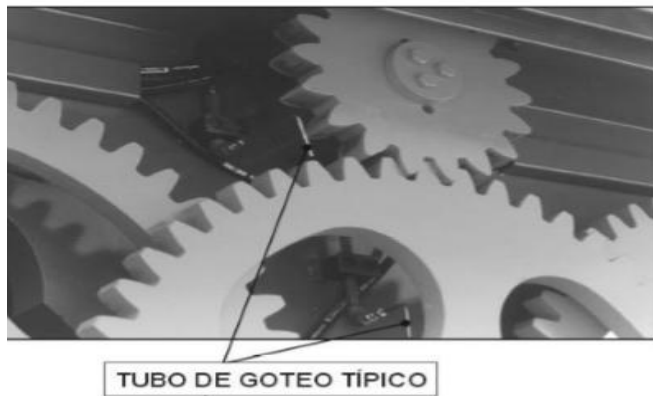
Figura 3-1 Lubricación de los engranajes del descortezador (Fuente: Descortezador A8)
