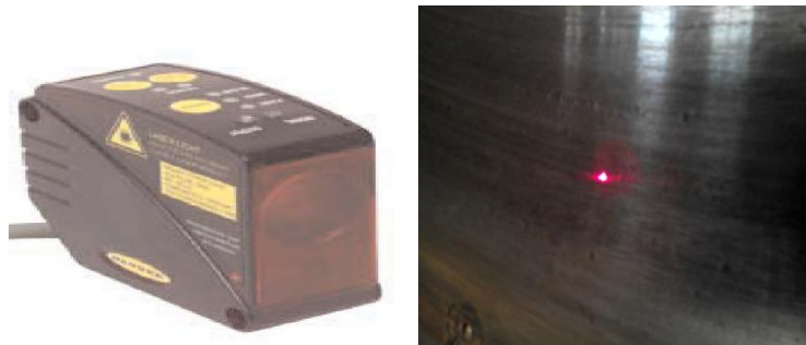
Figura 1-21 Laser de corte en la sierra 0 (Fuente: fotografía propia)
