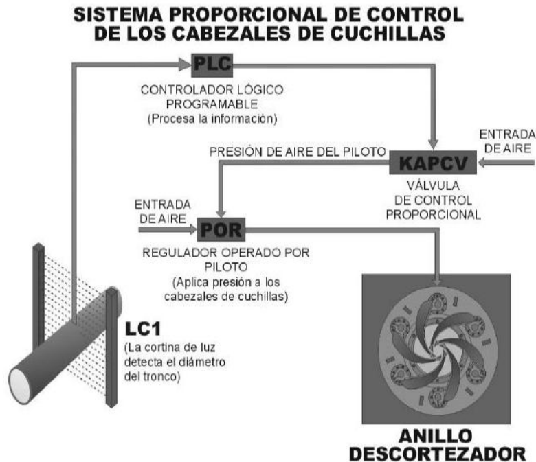
Figura 1-12 Sistema de control proporcional descortezador (Fuente: Descortezador A8)
