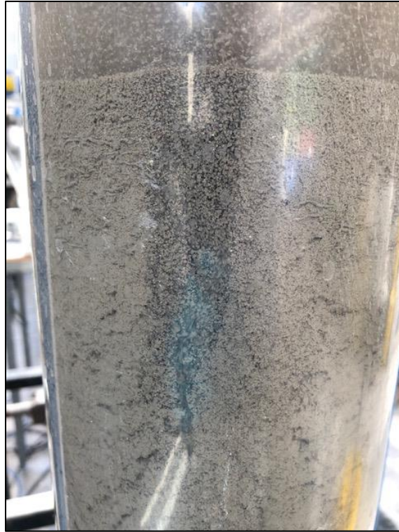
Figura 63. Canalización columna de 15 [gpt].
