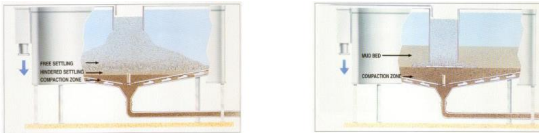
Figura 4. Comparación de la forma de alimentación de espesador convencional (izq.) y HRT (der.) [2].
