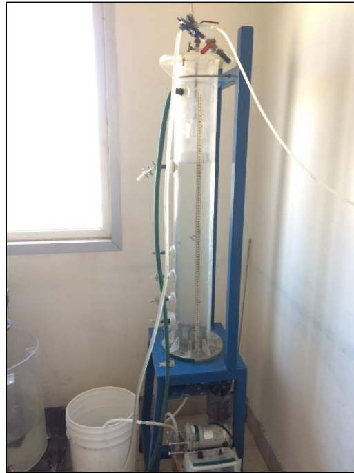
Figura 55. Columna semi-piloto de espesamiento.
