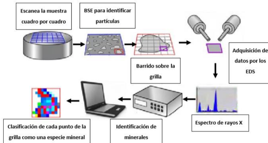
Figura 9. Diagrama del funcionamiento de análisis QEMSCAN [6].
