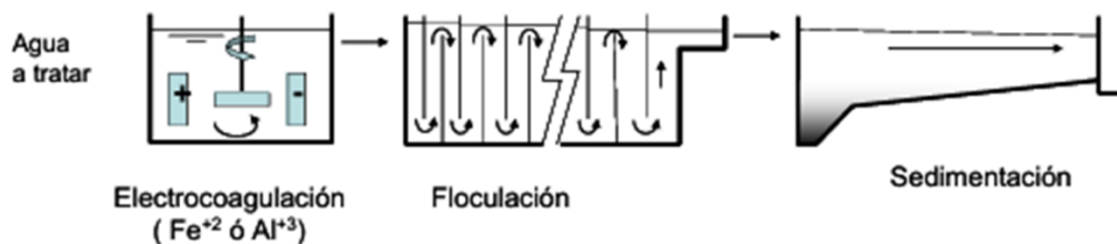
Figura 15. Proceso de electrocoagulación (Calderón, et al., 2010).
