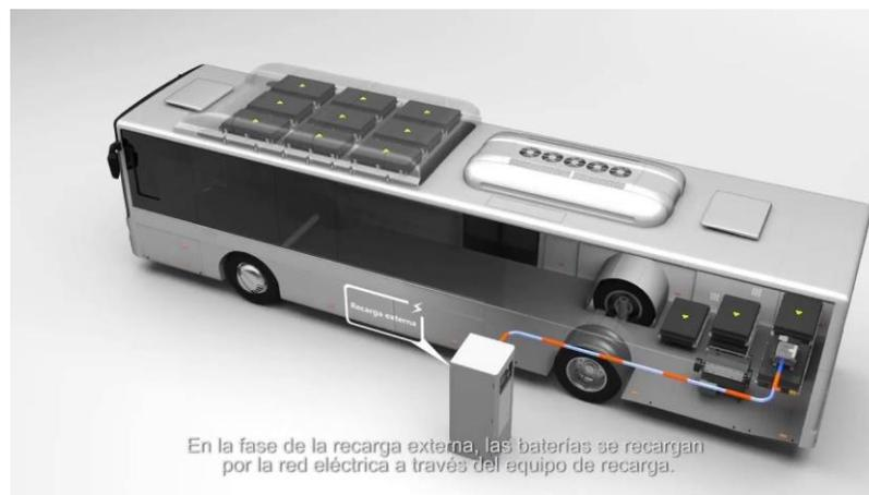
Figura: 1-13 diagrama de carga
