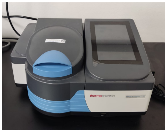
Figura 3.6: Equipo utilizado en ensayo estrocospía visible.
