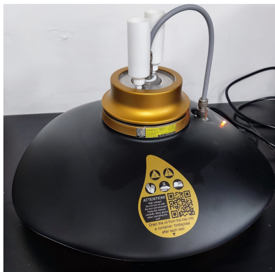
Figura 3.11: TOR-3 LSL utilizado para medición de tangente delta.
