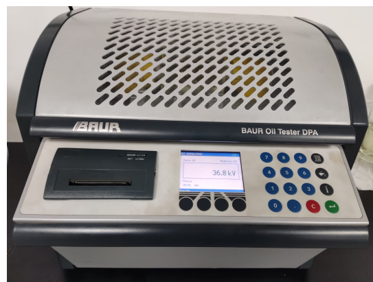
Figura 3.3: Equipo BAUR utilizado en ensayo Rigidez dieléctrica
