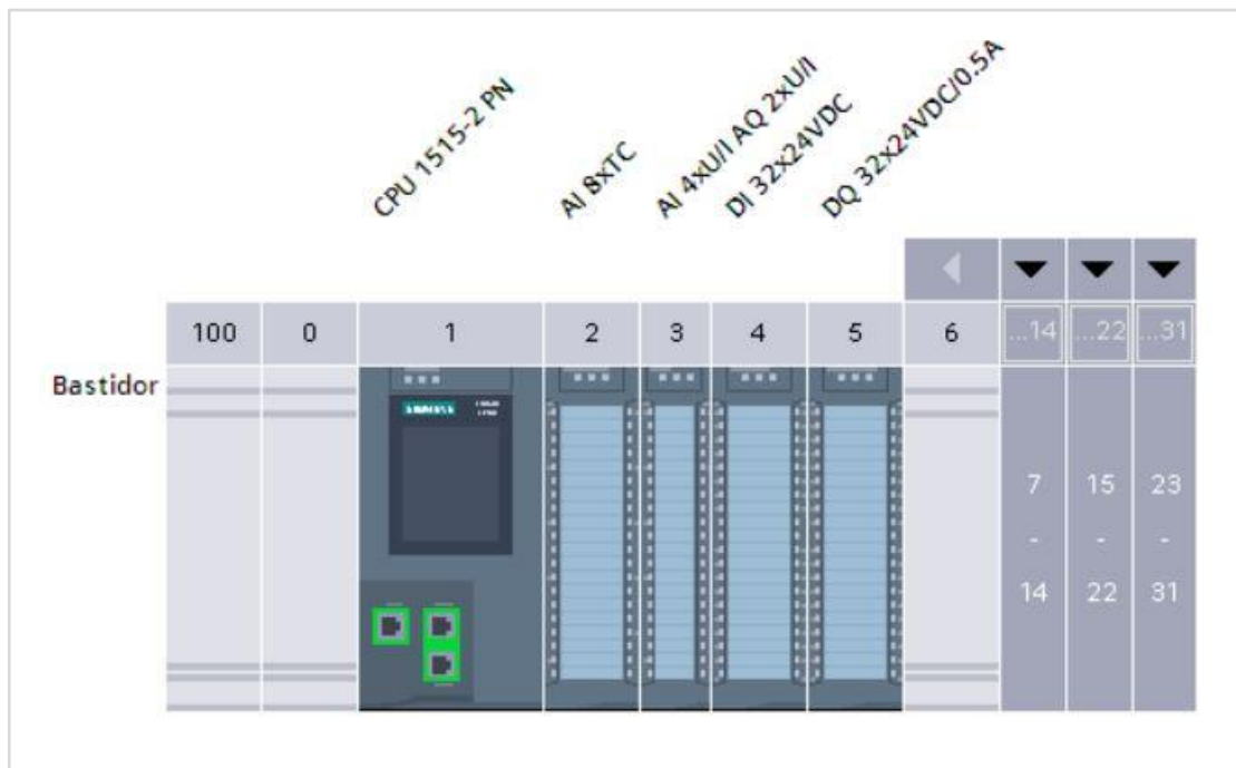
Figura 2-12. Configuración de hardware PLC extrusora.
