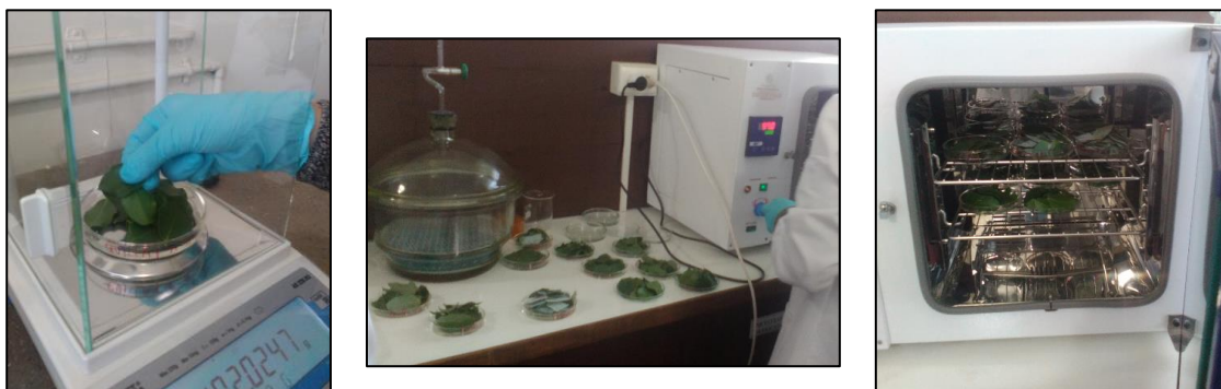
Figura 20: Determinación del contenido de humedad de las hojas de las especies forestales. Laboratorio de termodinámica UTFSM.
