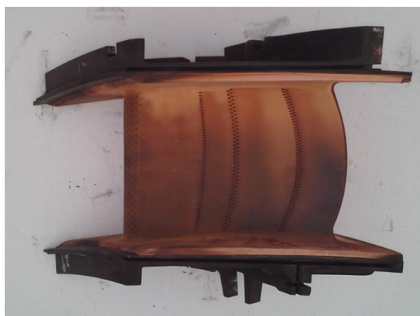
Figura 3.6: Alabe fijo de 1° etapa en turbina a gas M701F.
