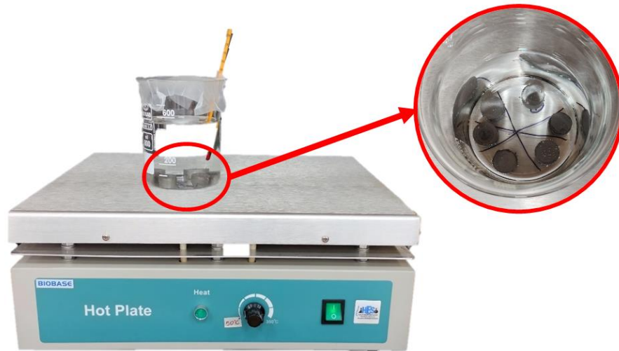
Figura 3.9 Montaje del plato caliente para realizar el ensayo de Arquímedes.
