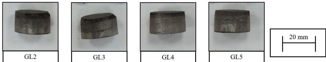
Figura 4.4 Registro fotográfico de las estructuras porosas con gradiente longitudinal sinterizadas a 1350 [°C] y a 1450 [°C].
