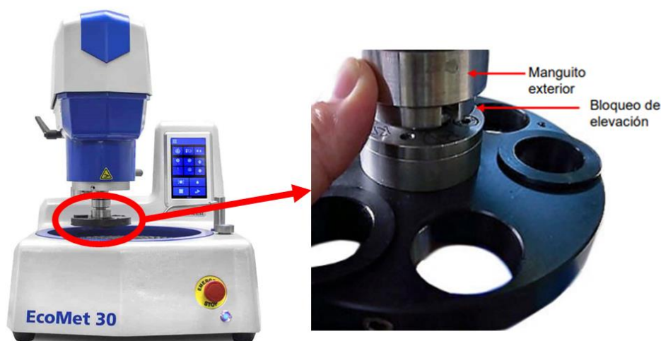
Figura 3.13 Equipo pulidor desbastador automático/manual ECOMET 30 de la marca Buehler indicando el soporte de muestras [83].
