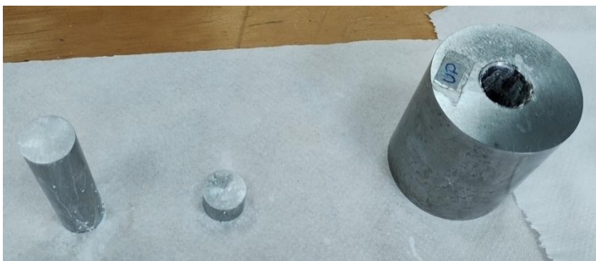
Figura 3.4 Matriz de 19,9 [mm] de diámetro cubierta por estearato de zinc.
