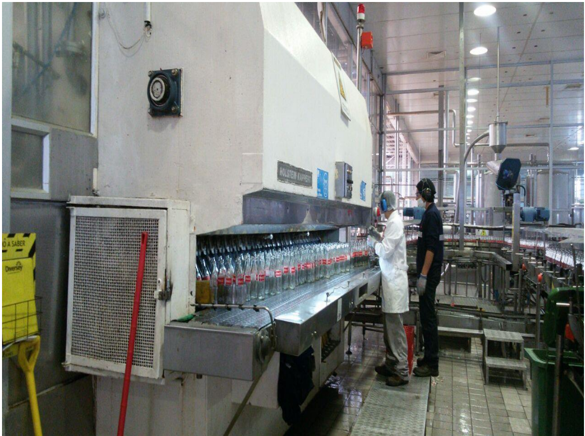
Figura 2.18 Inspección visual post lavado.
