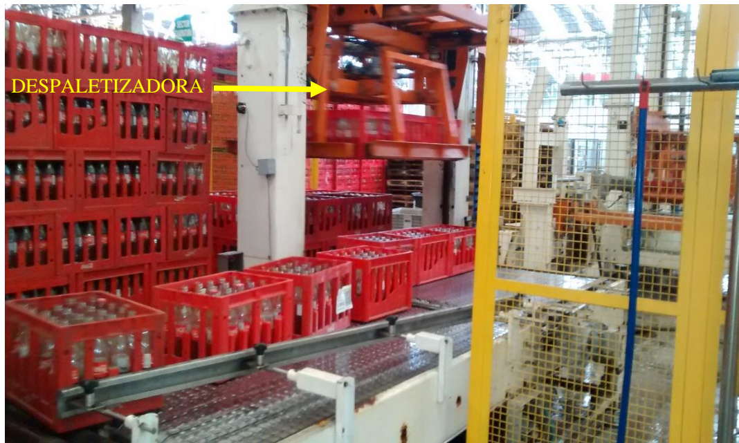
Figura 2.13 Despaletizadora colocando pallets vacíos en cinta transportadora
