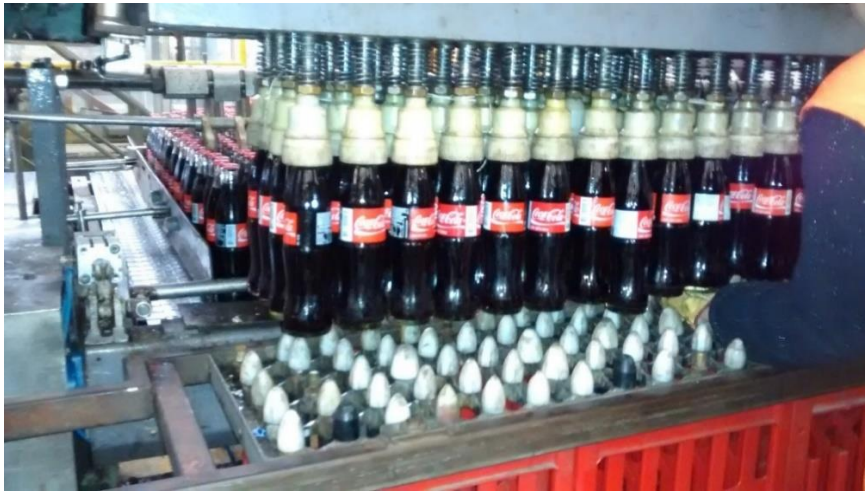
Figura 2.22 Encajonadora insertando el producto terminado en las jabs
