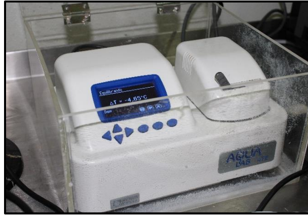
Figura 23 Higrómetro marca AquaLab, modelo Serie 4TE.
