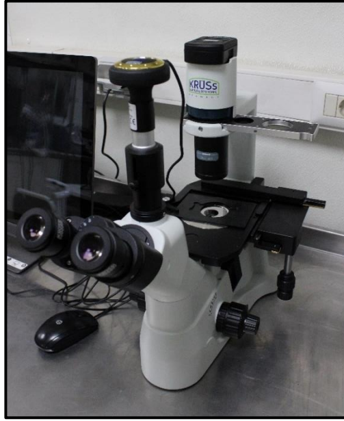
Figura 15 Microscopio invertido A.KRÜSS Optronic GmbH, modelo MBL3200.
