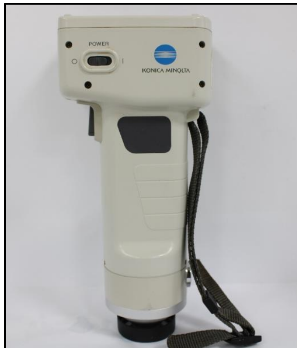
Figura 24 Colorímetro marca Konica Minolta, modelo CR-400.
