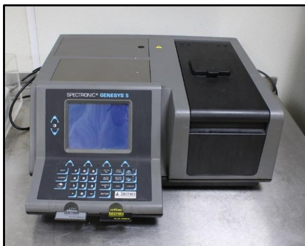
Figura 27 Espectrofotómetro UV/Vis Genesys 5, modelo Optimizen Pro.
