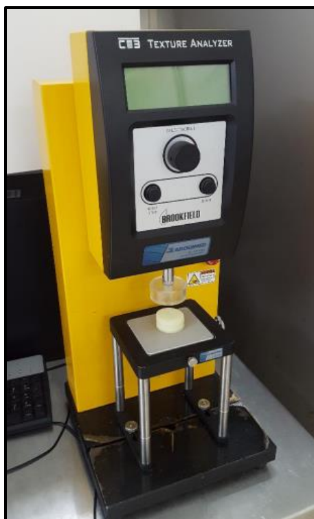
Figura 25 Texturómetro marca Brookfield, modelo CT3.
