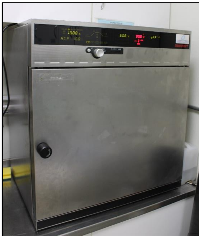
Figura 22 Estufa con control de humedad marca Memmert, modelo HCP-108.
