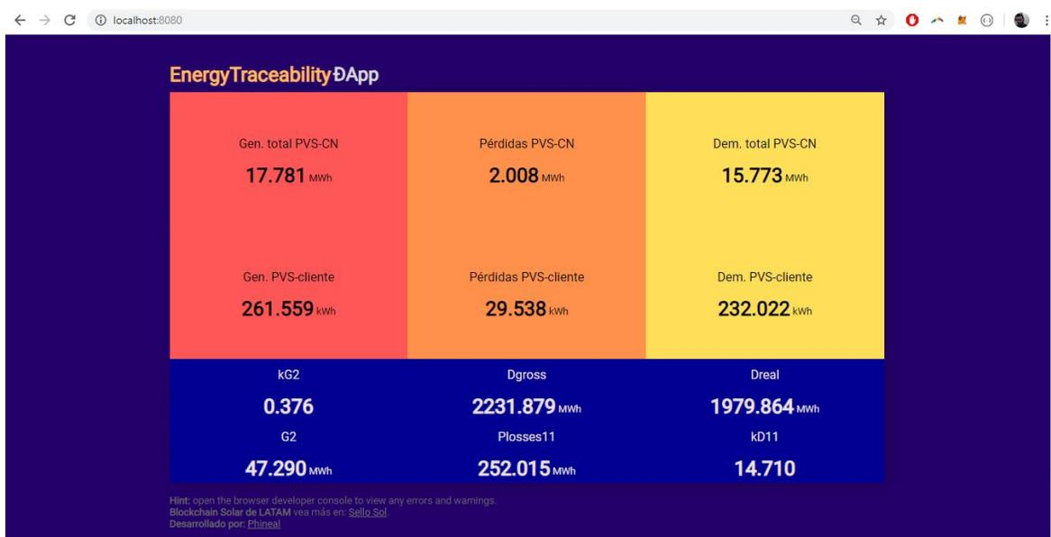
**Figura A.0.6:** Despliegue de la *DApp* en la dirección de “*loopback*” de un navegador web. Se aprecia la *cadena de suministro* instantánea a nivel de transmisión nacional (arriba) y a nivel del cliente final (abajo). Los parámetros incluidos en el cuadro azul corresponden a los resultados intermedios de la propuesta metodológica y sólo se incluyen para fines demostrativos. Elaboración propia.
