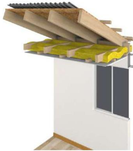
Imagen 28: solución constructiva techumbre
