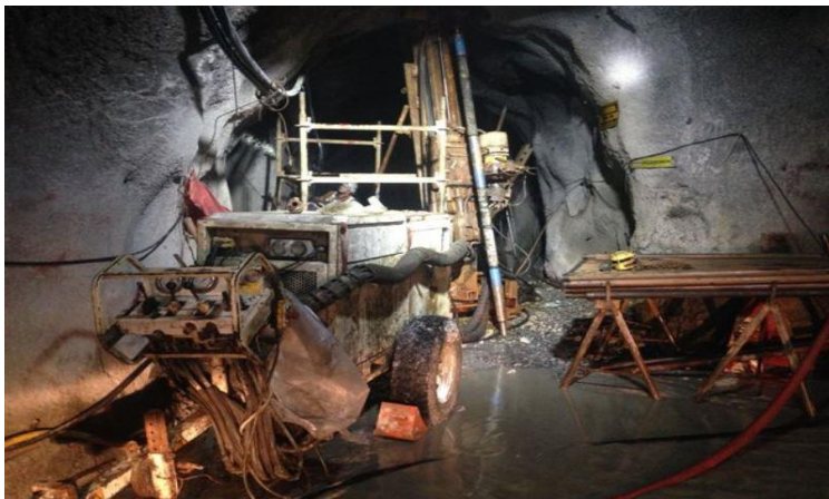
Figura 3.6: Sonda utilizada para realizar fracturamiento hidráulico. Fuente: Unidad PA, 2017.
