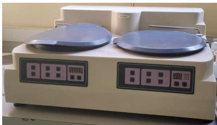
Figura 3 - 6: Estación de lijado y pulido.
