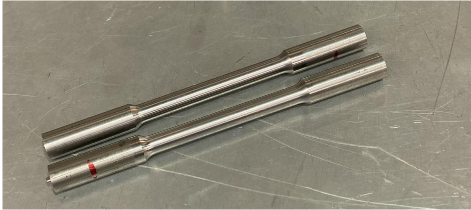
Figura 4 - 11: Fotografía de probetas de tracción de 9 milímetros de diámetro en la sección más angosta, fabricadas mediante CNC a partir de una barra de acero inoxidable 17-4PH de 12,5 milímetros de diámetro.
