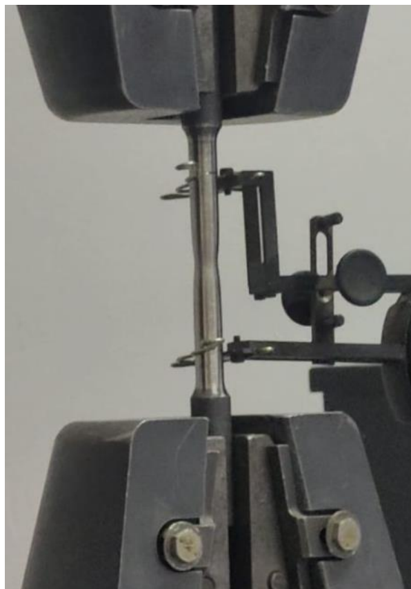
Anexo B XXI: Fotografía de cuello formado al llegar al UTS en el ensayo de tracción de probeta MT N°3, traccionada a 2.5 mm/min.
