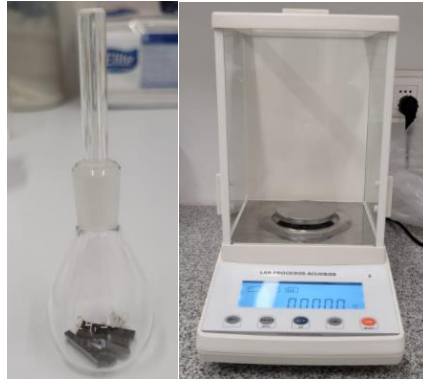
Figura 3 - 4: a) Picnómetro con un volumen certificado de 24.900 mL, con trozos de probetas fabricadas por ADAM en su interior. b) Balanza analítica electrónica de 5 cifras.
