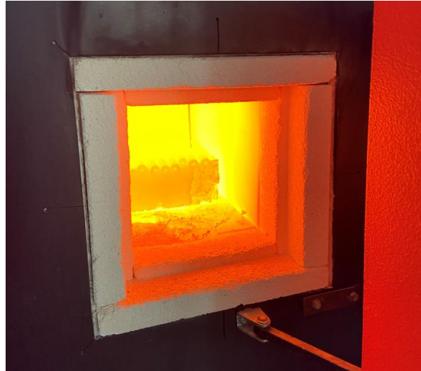
Figura 4 - 13: Tratamiento térmico de solución a 1050°C por una hora en horno BRASIMET a siete probetas cilíndricas de acero inoxidable 17-4PH pintadas con pintura refractaria.
