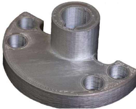
Figura 2 - 11: Brida de acero inoxidable 17-4PH fabricada a partir de ADAM [4].
