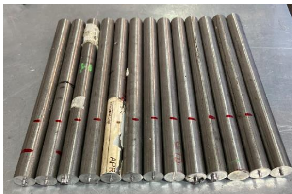
Figura 4 - 9: Trozos cortados de una barra de acero inoxidable 17-4PH adquirida en ENAER, con largos de 200 milímetros y diámetros de 12,5 milímetros.
