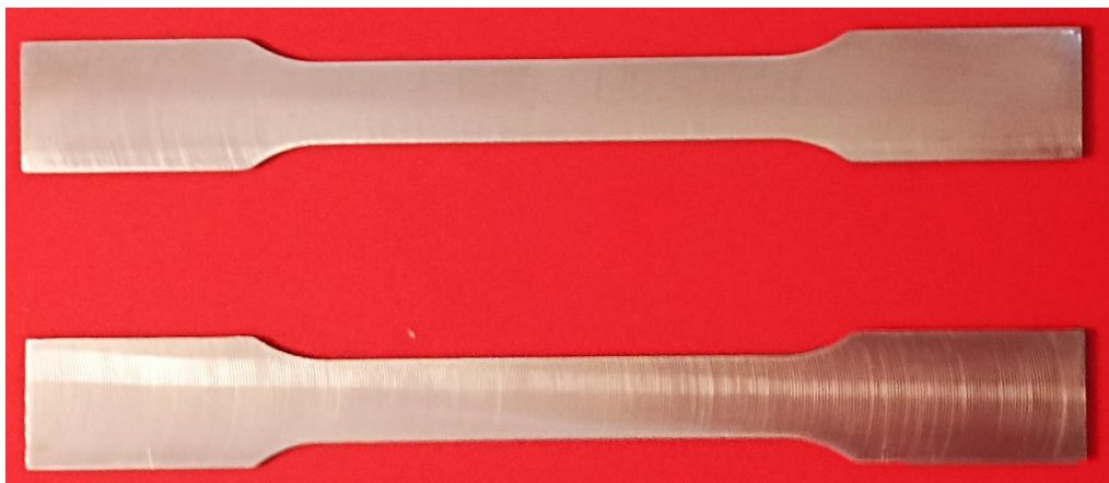
Figura 4 - 8: Fotografía de probetas de tracción de acero inoxidable 17-4PH, fabricadas a partir de ADAM después del mecanizado para mejorar calidad superficial.
