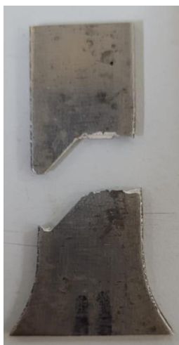
Figura 4 - 26: Fotografía de fractura de probeta de tracción MA N°45, traccionada a 2.5 mm/min.
