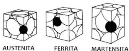
Figura 4 - 33: Estructuras cristalinas de austenita (centradas en las caras FCC), ferrita (centrada en el cuerpo BCC) y martensita (tetragonal BCT). El círculo negro representa un átomo de carbono.
