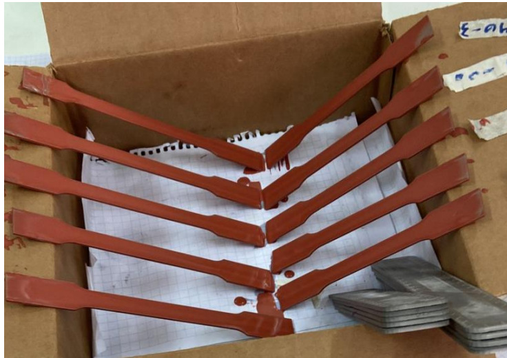
Figura 4 - 12: a) Fotografía de probetas de tracción fabricadas mediante ADAM, pintadas con pintura ALFACARB.
