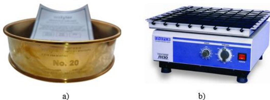
Figura 4. Equipos utilizados en el tamizado a) Tamiz W.S. TYLER N°20 b) Shaker orbital FINEPCR modelo SH30.
